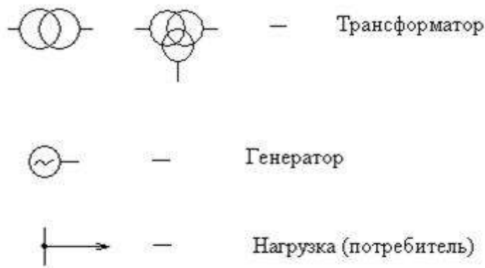
Рисунок 3. Условные обозначения основных элементов электроэнергетической системы.
